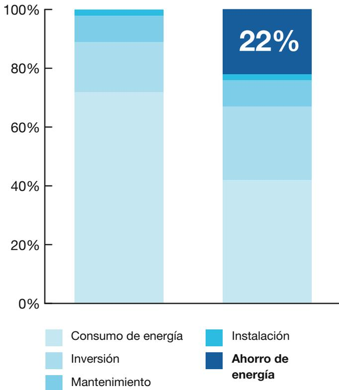
La mayor parte del tiempo, el consumo de aire en la red no es constante. Un compresor de velocidad variable reduce el régimen del motor principal para seguir con precisión el perfil de consumo de aire comprimido. Como resultado, se consigue un considerable ahorro energético.
