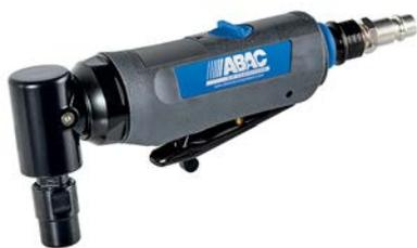
Meuleuse d'angle pour applications multiples dans des espaces restreints. Conception compacte et légère. Poignée ergonomique en caoutchouc avec vibrations réduites. Raccord d'air orientable pour une plus grande flexibilité. Mandrin à pince de 3 mm et 6 mm inclus.
