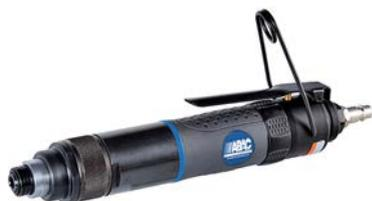
Visseuse compacte pour une utilisation professionnelle dans l'industrie du bois et du métal. Poignée ergonomique antidérapante. Bruit extrêmement faible grâce au silencieux d'échappement d'air. Le réglage sans tige du couple sur la bague de réglage extérieure permet un travail flexible. Adaptée pour s'accrocher à des balanciers.
