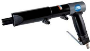
Marteau à aiguilles universel pour des applications de détatrage. Dans la construction et l'industrie de la métallurgie. Poignée revolver pour une meilleure ergonomie. Guide aiguille réglable pour s'adapter aux différentes applications. Poignée en caoutchouc pour réduire les vibrations.
