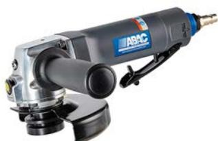
Meuleuse d'angle puissante pour une utilisation professionnelle dans l'industrie métallurgique. Changement extrêmement rapide du disque de meulage grâce au blocage de l'arbre. Poignée latérale en caoutchouc pouvant être montée pour les gauchers et les droitiers. Carter de protection réglable sans outil, pour une protection contre les étincelles. Pour meules standard jusqu'à ø maxi. 125 mm.
