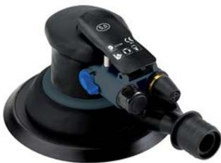
Ponceuse orbitale universelle avec course de 5mm. Ponçage sans fatigue grâce à des vibrations réduites. Vue illimitée de la pièce à usiner avec collet étroit. Consommation d'air particulièrement basse. Convient pour papier abrasif standard 150mm, 15 trous, 8 trous et 6 trous.
