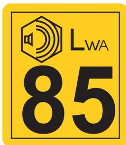
Valeurs sonores sur l'étiquette du compresseur : Conformément à la réglementation CEE, il est obligatoire d'afficher clairement le niveau de puissance acoustique (LWA) sur tous les compresseurs d'air.
