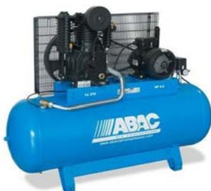
Compresseurs à pistons avec blocs en fonte : une gamme fiable et robuste, construite avec des composants de première qualité. Les pompes fonctionnent à basse vitesse, afin de garantir des niveaux de bruit et des températures de fonctionnement plus faibles, ainsi qu'une durée de vie plus longue, mais elles n'en garantissent pas moins d'excellentes performances et sont parfaitement adaptées aux applications les plus exigeantes et les plus intensives.
