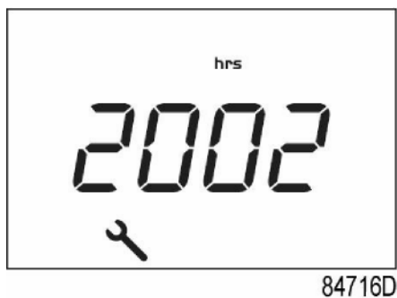
Esempio di schermata delle ore di funzionamento
