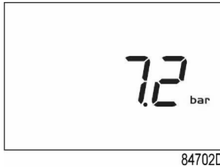
Schermata principale con pressione (compressore spento)
