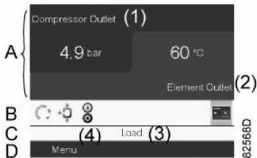
Schermata principale tipica (2 linee di valori), compressori a velocità fissa | Schermata principale tipica (4 linee di valori), compressori a velocità fissa
