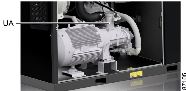
Figura 26: Posizione dello scaricatore/della valvola di ingresso
