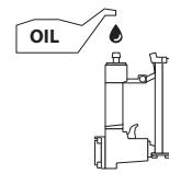
Obrišite višak ulja na izlazu. Višak ulja može da ošteći zaptivne O-prstenove alata. Ako se koristi sistem za podmazivanje, nije potrebno dnevno ručno podmazivanje putem otvora za ulaz vazduha.
