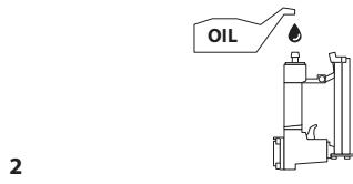
A kiengedésnél a felesleges olajat törölje le! A felesleges olaj tönkreteheti a szerszám tömítőgyűrűit. Amennyiben kenőberendezést használ, nem szükséges naponta, a légybevezető nyílásban át kézzel végeznie a kenést.
