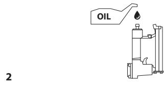
Togliere, strofinando, l'olio in eccesso presente nello scarico. L'olio in eccesso potrebbe danneggiare le guarnizioni o-ring dell'utensile. Se si utilizza un impianto di lubrificazione , non sarà necessario eseguire giornalmente la lubrificazione manuale attraverso l'ingresso aria.
