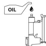
Enlever, en frottant, l'excès d'huile présente dans le refoulement. Un excès d'huile peut endommager les joints toriques de l'outil. Si un système de lubrification est utilisé, une lubrification manuelle par l'entrée d'air n'est pas nécessaire quotidiennement.
