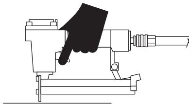
Отпускайте спусъка след всяко изстрелване. Преместете инструмента в следващото положение и повторете горната процедура.
