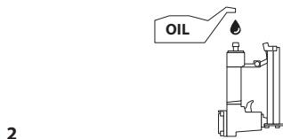
Otrite prebytočný olej, ktorý sa nachádza vo vypúšťacom otvore. Prebytočný olej by mohol poškodiť tesniace o-krúžky. Pri použití mazacieho rozvodu nebude potrebné denne manuálne mazať cez prívod vzduchu.
