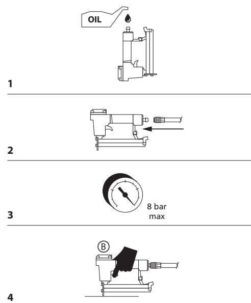
**VAROVANIA:** neprekračujte hodnotu 8 barov (0,8 MPa)
