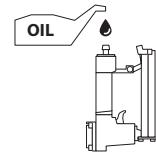
Retirar com um pano o óleo em excesso presente na descarga. O óleo em excesso pode danificar os vedantes o-ring da ferramenta. Caso se utilize um sistema de lubrificação, não será necessário executar diariamente a lubrificação manual através da entrada de ar.
