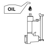
Obrište suvišak ulja na izlazu. Suvišak ulja može oštetiti brtve (O-prstene) alata. Ako se koristi naprava za podmazivanje, nije potrebno vršiti dnevno ručno podmazivanje kroz ulaz zraka.
