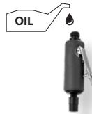
Obrišite odvečno olje v odprtini. Odvečno olje lahko poškoduje tesnila tesnilnega obročka orodja. Če uporabljate mazalni sistem, vsakodnevno ročno mazanje skozi priključek za dovod zraka ni potrebno.
