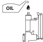
Сотрите излишки масла с выхлопного отверстия. Излишки масла могут повредить кольцевые прокладки инструмента. Если используется система смазки, то в ежедневной смазке через отверстие подачи воздуха нет необходимости.
