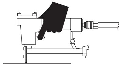
Laat de trekker na elk schot los. Verplaats het gereedschap naar de volgende positie en herhaal de bovenstaande procedure opnieuw.
