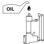
A kiengedésnél a felesleges olajat törölje le! A felesleges olaj tönkreteheti a szerszám tömítőgyűrűit. Amennyiben kenőberendezést használ, nem szükséges naponta, a légybevezető nyíláson át kézzel végeznie a kenést.
