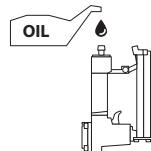
Frote para sacar el aceite excedente que pueda haber en la descarga. El excedente de aceite puede dañar las juntas tóricas de la herramienta. Si se utiliza una instalación de lubricación, no es necesario lubricar todos los días manualmente a través de la entrada de aire.
