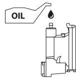
Otrite prebytočný olej, ktorý sa nachádza vo vypúšťacom otvore. Prebytočný olej by mohol poškodiť tesniace o-krúžky. Pri použití mazacieho rozvodu nebude potrebné denne manuálne mazať cez prívod vzduchu.
