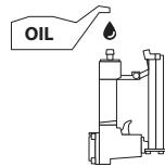
Otřete přebytečný olej, který se nachází ve vypouštěcím otvoru. Přebytečný olej by mohl poškodit těsnící O-kroužky. Při použití mazacího rozvodu nebude třeba denně provést manuální mazání prostřednictvím vstupu pro vzduch.
