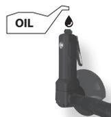
Essayez l'excédent d'huile à la sortie. Un excédent d'huile peut endommager les joints toriques de l'outil. Si un système de lubrification est utilisé, la lubrification manuelle quotidienne par l'entrée d'air n'est pas nécessaire.
