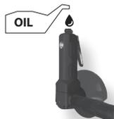
Veeg een eventueel teveel aan olie in de uitlaat weg. Het teveel aan olie kan de afdichtingen van de O-ringen van het gereedschap beschadigen. Als een smeersysteem wordt gebruikt, is het niet nodig om dagelijks handmatig te smeren via de luchtinlaat.
