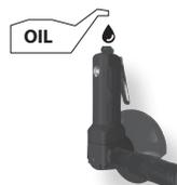
Zetrzeć nadmiar oleju z wylotu. Nadmiar oleju może uszkodzić pierścienie uszczelniające typu „o” narzędzia. W przypadku zastosowania układu smarowania ręczne smarowanie przez wlot powietrza nie będzie konieczne codziennie.
