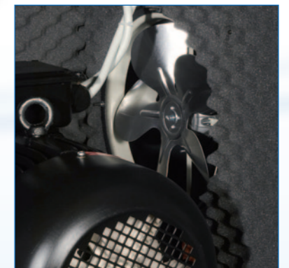
Refrigeración con ventilador eléctrico adicional (en unidades de 7,5 y 10 CV)
